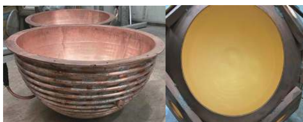
图 7 盘管焊接和积分球真空镀金效果实物图
