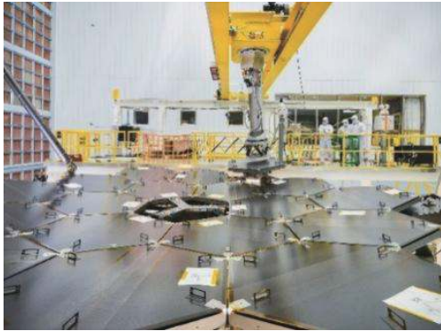
图 6 JWST 采用机器人进行主镜装调
