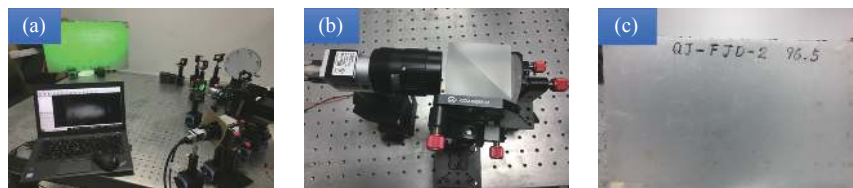
图 8 系统测量装置。(a) 测量平台及场景; (b) 迈克尔逊剪切装置; (c) 被测物
