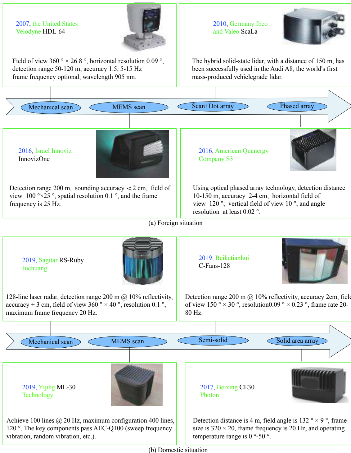
图 3 国内外车载三维成像激光雷达典型产品对比图
