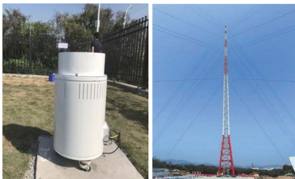
图 6 激光测风系统与气象梯度观测塔
