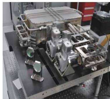
图 9 激光器 1 发射 532 nm 和 1 064 nm 的工作台 Fig.9 Work table for laser1 emitted 532 and 1 064 nm
