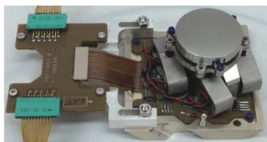
图 17 光束转向机构
