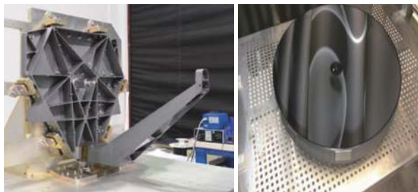
图 20 望远镜及主镜结构
