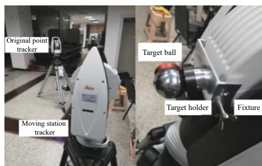
图 5 自标定示意图与夹具连接示意图
