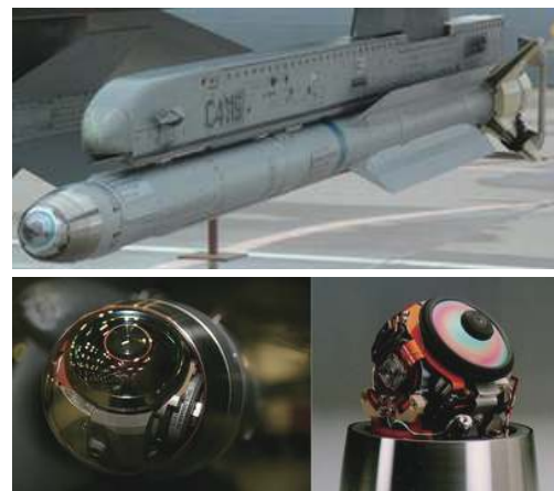
图 7 IRIS-T 导弹及其导引头光学系统
