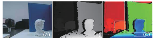
图 9 提出的算法对 Realsense D415 深度相机获取的视差图序列(第 2 帧)的处理结果。(a) RGB 图像;(b) 视差图;(c) 分割结果在伪彩视差图上的标注框
