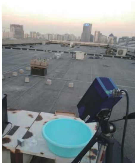
图 11 中波波段水面偏振度测量实验场景图
