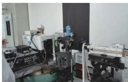
图 4 基于 CO 2 激光器的绝对光谱位置校正测试现场
