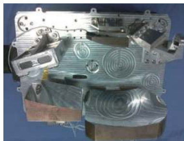
图 2 低温腔体内红外分光计结构
