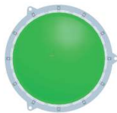
图 3 镜片装框的应力卸载设计模型图
