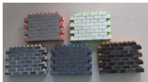
图 3 喷涂的不同反射率涂层表面母块图
