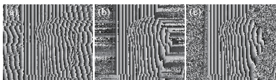
图 14 不同相位提取算法比较。(a) 傅里叶变换法; (b) 去背景傅里叶变换法; (c) 背景归一化傅里叶变换法
