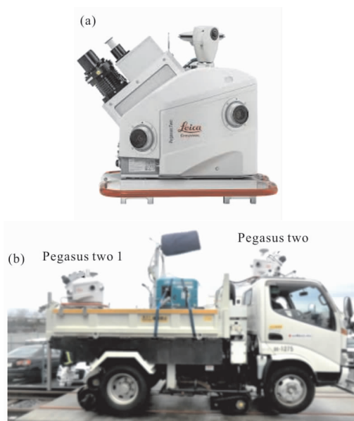
图 3 Leica 制 Pegasus Two 型车载移动测量系统及实验用铁路轨检车
