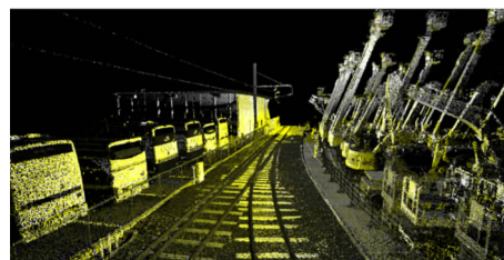
图 7 联合约束检校后两系统激光点云叠合图
