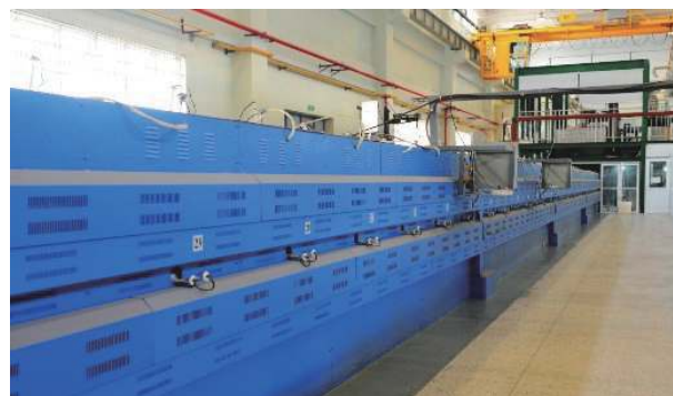
图 3 磷酸盐钕玻璃连续熔炼生产线
