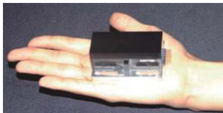
图 6 掌上大小 GHz 飞秒激光器 [45]
