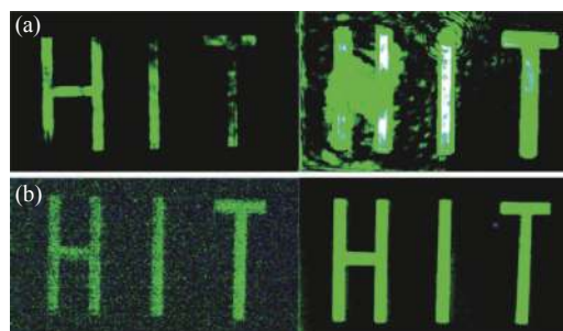
图 11 “HIT”的无斑点成像。(a) 用传统的激光二极管照明; (b) 用表面发射随机激光器照明, 最小特征尺寸约 3 μm [208]
