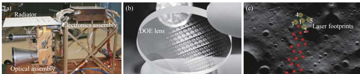
图 6 LOLA 系统组成 (a)、核心 DOE 分光器件 (b) 及月面足印分布示意图 (c)
