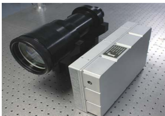
图 9 高重复窄脉冲多光束输出激光器实物
