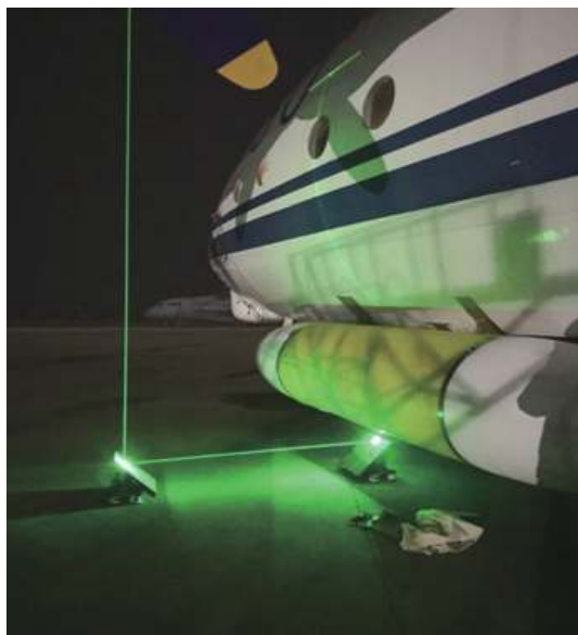
图 5 大气探测激光雷达校飞样机测试
