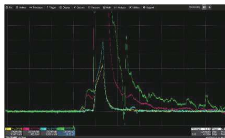
图 4 两台整形脉冲产生辐射流示波器测量结果: 通道 1 和 3 为完整信号; 通道 2 和 4 为调整量程后的低通信号
