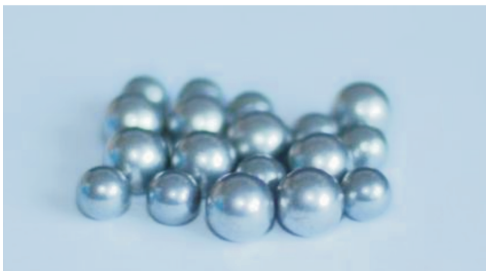
图 6 测试使用的铝球(6.35 mm 和 8 mm)
