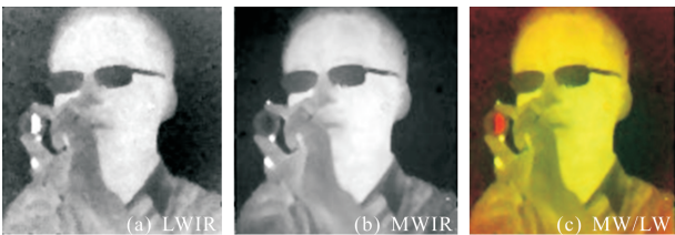
图 7 中波/长波碲镉汞双色焦平面器件成像
