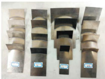
图 2 激光圆弧扫描弯曲样件
