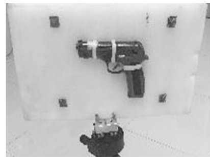
(a) 包含玩具手枪和角反射器的实验目标光学图像
