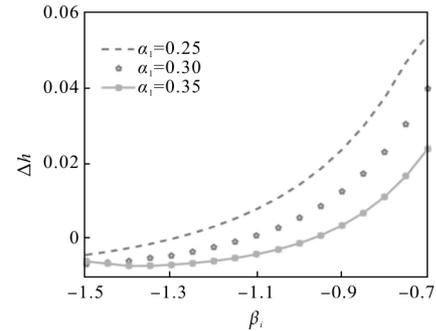
图 7 三镜边缘光线高度与经四镜反射处光线高度差随次镜放大率变化曲线图
