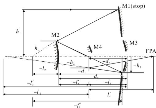
图 1 同轴四反射光学系统示意图
