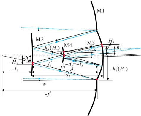
图 3 入射高度为  $-h_1'$  时轴上和轴外光线光路图
