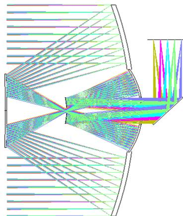
图 10 同轴四反射镜光学系统光路图
