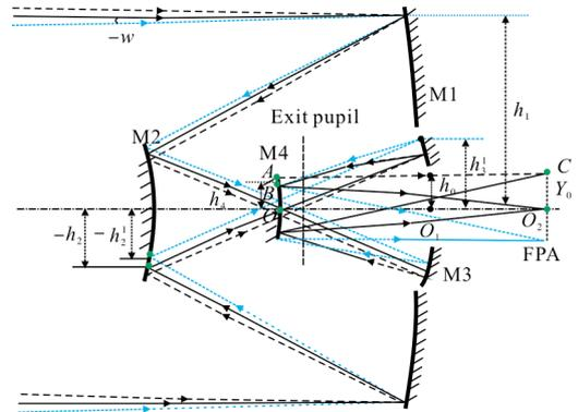
图 4 轴外边缘光线和轴上边缘光线光路图
