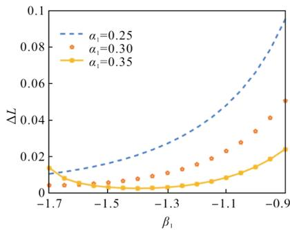
图 6 出瞳到四镜的距离随次镜放大率变化曲线图
