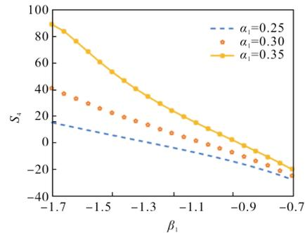
图 8 场曲  $S_4$  随次镜放大率变化曲线图
