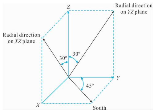
图 2 系统出射光方向示意图
