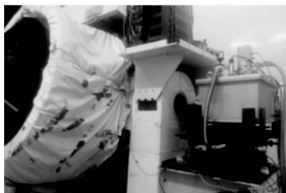
图 11 冷光学终端与大口径望远镜对接
