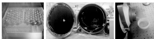
(c) 常压热真空循环 (d) 热真空(-140~+160 ℃) (e) 极端液氮测试 (-170~+160 ℃) (c) Atmospheric thermal vacuum cycle (d) Thermal vacuum (-140~+160 ℃) (e) Extreme nitrogen test (-170~+160 ℃)
