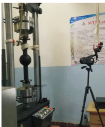
图 2 疲劳试验中的 MTS 与红外系统 Fig.2 MTS and infrared system in fatigue test
