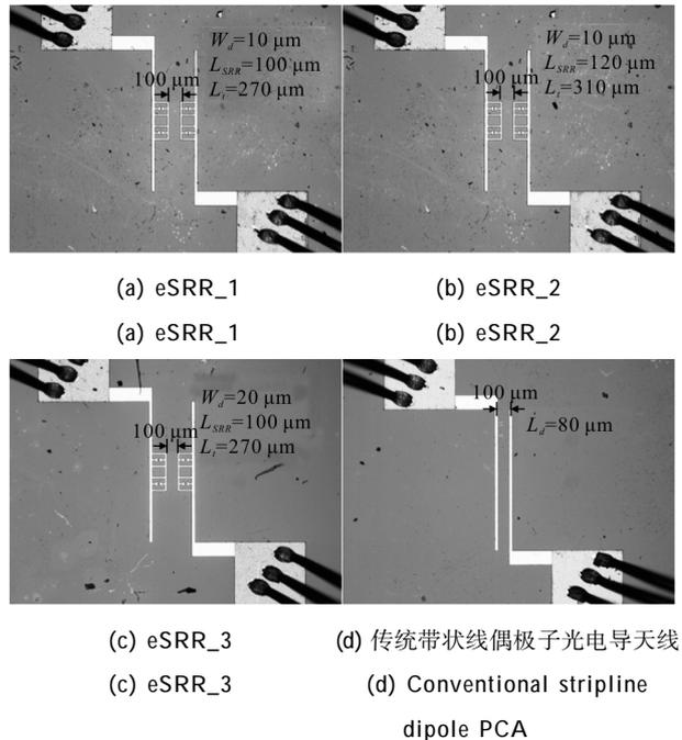
图 7 不同尺寸的新型天线和传统带状线偶极子光电导天线实物图
