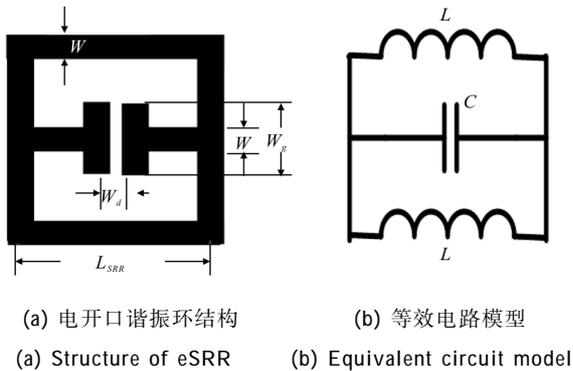
图 1 电开口谐振环结构及等效电路
