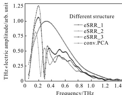
图 9 实测新型和传统光电导天线辐射的归一化频谱
