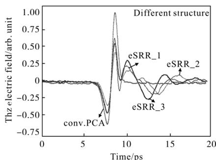
图 8 新型和传统光电导天线辐射的 THz 归一化时域波形
