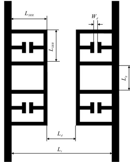
图 6 微结构光电导天线结构示意图
