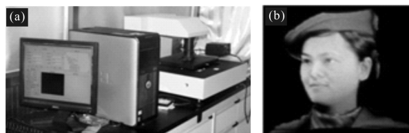
图 8 王辉团队研制的彩虹全息图打印系统(a)与彩虹全息图再现效果(b)
