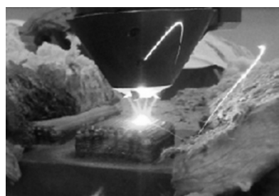
图 3 激光立体成形原理图
