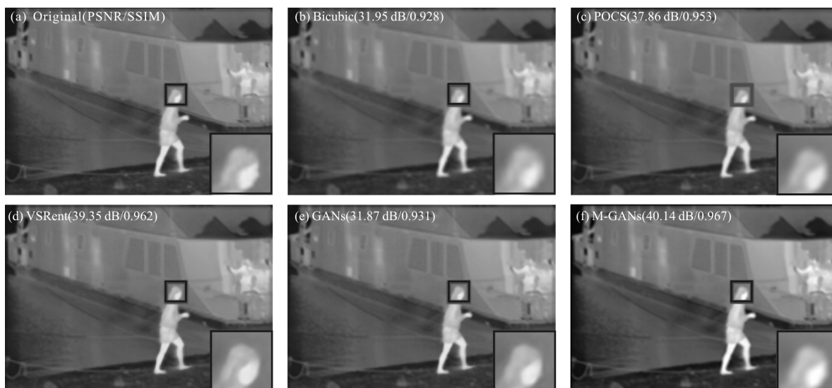
图 8 “女人”图像使用不同超分辨率重建方法的重建结果及质量评价 (PSNR 和 SSIM), 尺度因子为 3, 图像大小为 399 pixel×279 pixel
