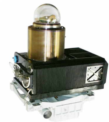
图 2 俄罗斯 President-s 专机用于防御 MANPADS 的 DIRCM 系统 Fig.2 DIRCM system of Russia President-s airplane for MANPADS defence
