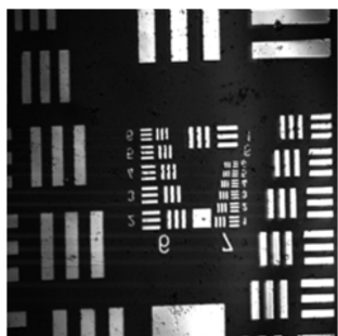
图 12 扫描 USAF1951 分辨率板所成图像
