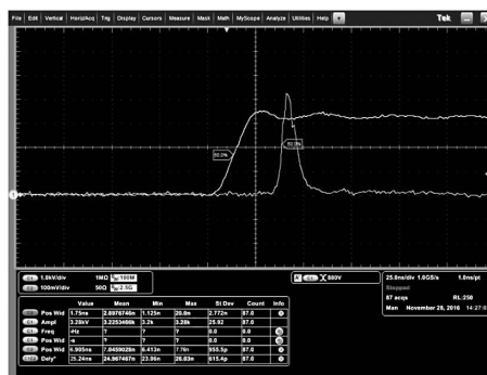
图 10 激光脉冲波形
