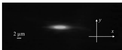
图 5 波长 1 550 nm 下 Er:Ta 2 O 5 脊形波导近场模式 Fig.5 Near-field pattern of Er:Ta 2 O 5 ridge waveguide on Si substrate at wavelength of 1 550 nm
