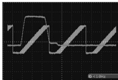
图 9 锯齿波调制情况下, 无甲烷气体的吸收波形图
