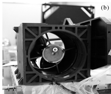
图 4 离轴三反发射光学系统和 300 mm 接收系统 (焦面放置光纤阵列)
