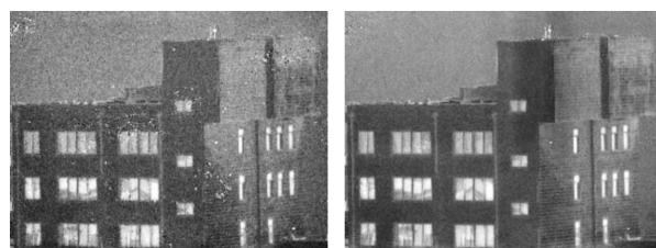
(c) 校正前场景 2 偏振度图像 (d) 校正后场景 2 偏振度图像 (c) Polarization image of scene 2 before NUC (d) Polarization image of scene 2 after NUC
