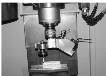
图 5 加工中心在机三维检测系统
