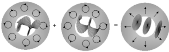
图 1 螺旋光束合成径向矢量光束的原理图
