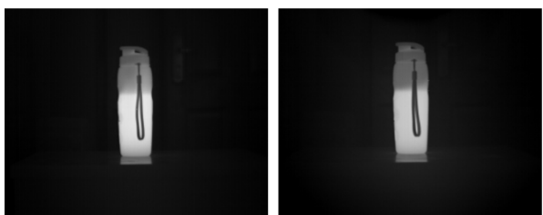
(a) 无偏振辐射强度图像 (b) I 参数图像 (a) Radiation intensity image without polarization (b) I parameter image
