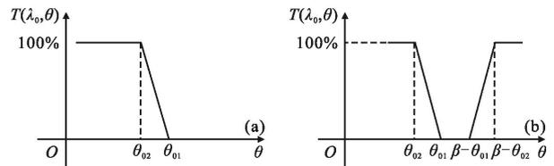
图 4 长波通截止滤光片 C1 的角谱透射率(a)经该装置的角谱透射率(b)
