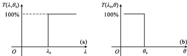
图 2 理想长波通截止滤光片光谱透射率(a)和角谱透射率(b)
