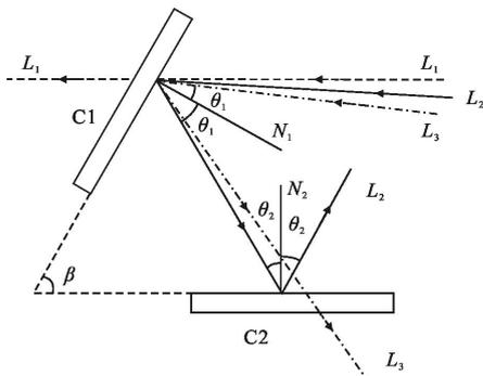
图 5 基于短波通截止滤光片的空间滤波装置
