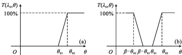
图 6 (a)短波通截止滤光片 C1 的角谱透射率(b)经该装置的角谱透射率
