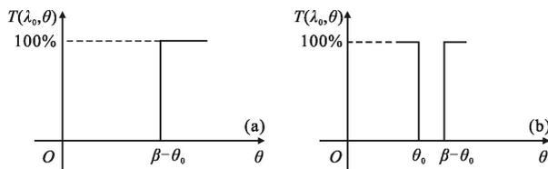
图 3 当 C1 仅为高效率反射透镜时,该装置的角谱透射率(a)和当 C1 和 C2 为同一长波通截止滤光片时,该装置的角谱透射率(b)
