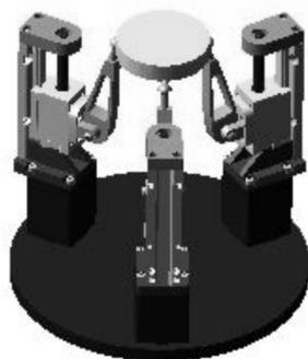
图 2 小型 3-PRS 机构 UG 模型
