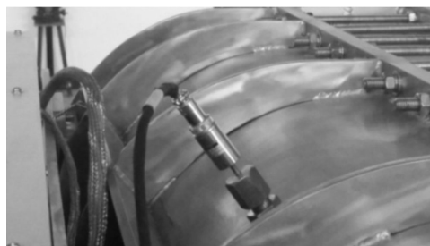
图 5 温度传感器安装位置图
