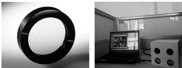
(a) 长波红外偏振成像系统所采用的偏振片 (b) 长波红外偏振成像系统实物图
