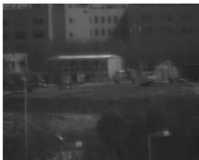
(b2) 波前编码镜头离焦 1 mm
