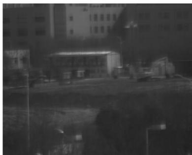
(a2) 波前编码镜头离焦 0.8 mm
