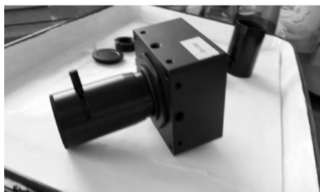
图 7 加工的光机元件及组装好的 CMOS 大焦深相机
